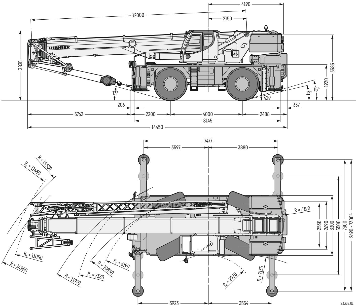
$R_1$  = Allradlenkung · All-wheel steering · Direction toutes roues · Tutti gli assi sterzanti · Dirección en todos los ejes · Поворот всеми колесами
