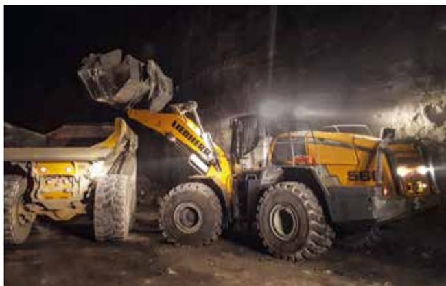
L 566 загружает самосвалы грузоподъемностью до 45 тонн.
