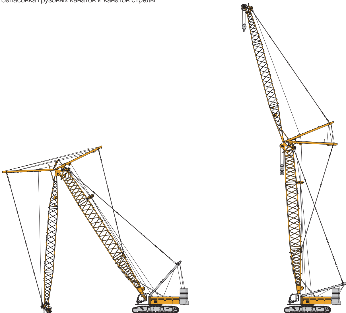
Подъём основной стрелы и управляемого удлинителя стрелы
