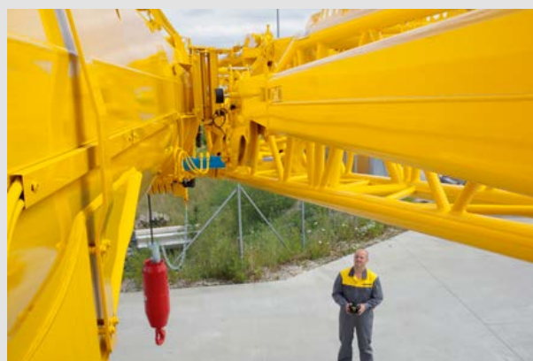
Гидравлическое монтажное приспособление для установки откидного удлинителя управляемое при помощи БТТ
