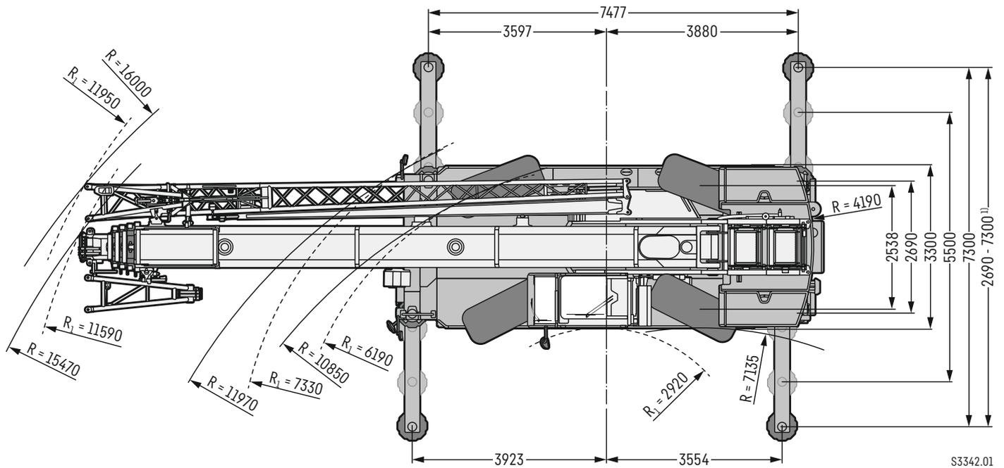
R<sub>1</sub> = Allradlenkung • All-wheel steering • Direction toutes roues • Tutti gli assi sterzanti • Dirección en todos los ejes • Поворот всеми колесами
