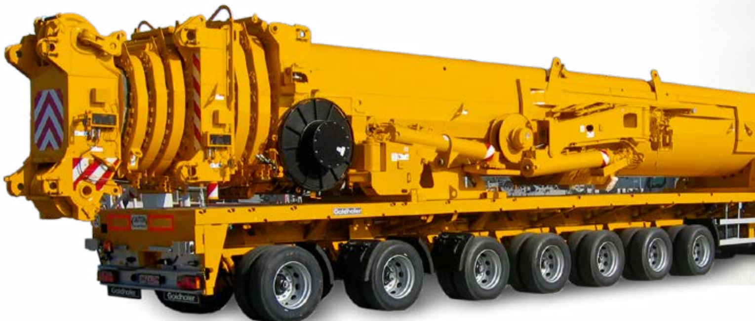
Телескопическая стрела 100 м + Y-портал Данные по весу без стрелового подъёмного устройства
