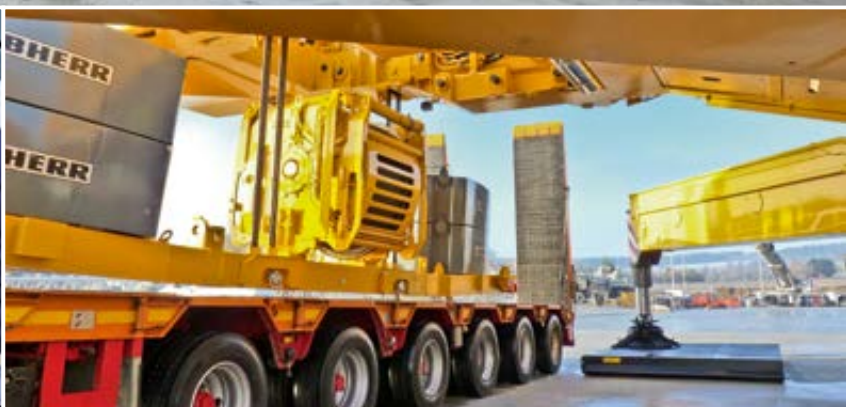
Самомонтаж механизма подъёма 2
