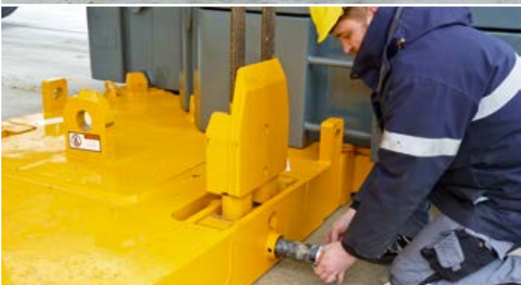
Простое скрепление пальцами несущей плиты противовеса с балластировочным устройством
