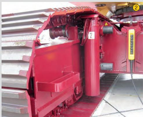
2 Цилиндры самоподъёма со втянутой гусеничной тележкой
