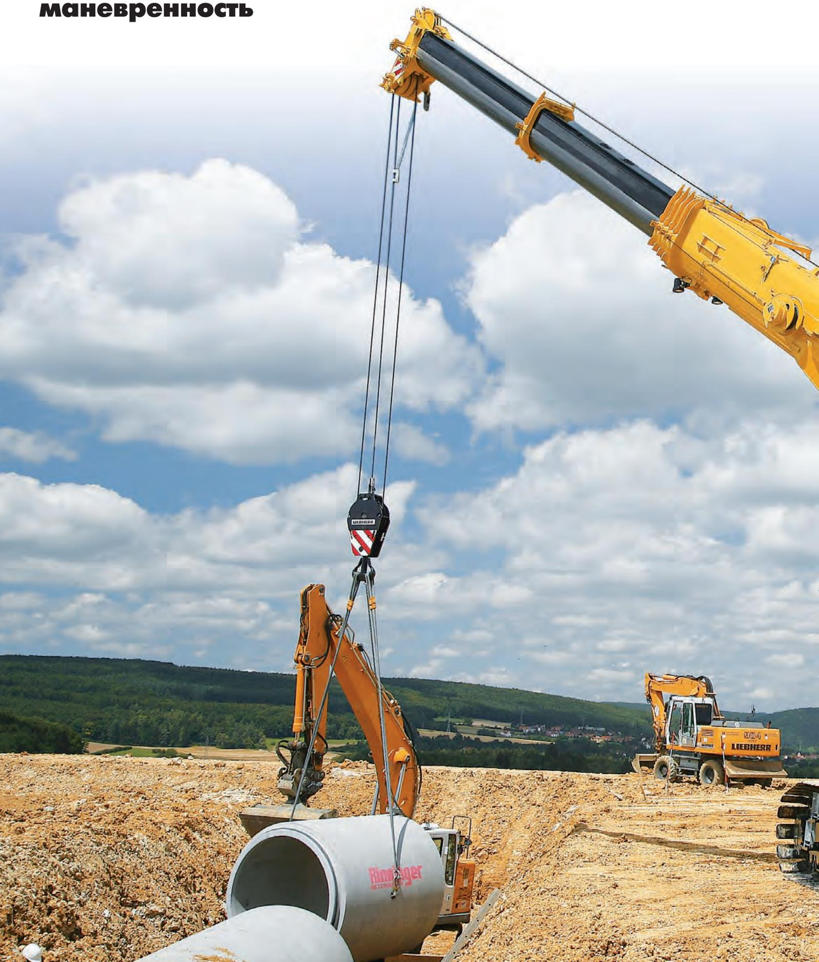
Основными особенностями телескопического гусеничного крана LTR 1100 производства концерна „Либхерр“ являются длинная телескопическая стрела, высокая грузоподъемность, исключительная мобильность, а также широкий набор оборудования, обеспечивающего комфорт и безопасность. 100- тонник предлагает самые передовые технологии для большей пользы в практической работе.
