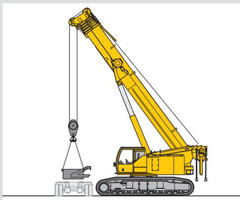
Быстрая и экономичная балластировка центрального балласта и балласта поворотной платформы благодаря само-монтажу.
